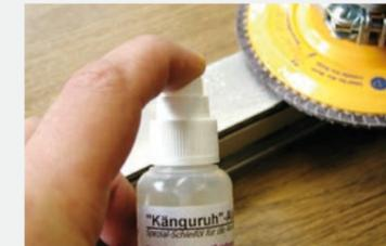
Das einzigartige Spezialöl für die Alubearbeitung verhindert das „Zuschmieren“ der Fächerschleifscheiben **und erhöht die Standzeit und Leistung bis zu 300%**! Einfach vor dem Schleifen auf das Werkstück aufsprühen und wie gewohnt schleifen.
