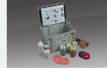
Das 3M Poliersystem für die Reparatur von Defekten auf Glasoberflächen. Zerkratzte Oberflächen werden je nach Kratztiefe mit 1 bis maximal 3 Schleifschritten aufbereitet. Die Polierstufe erzielt die optische Klarheit. Schneller Schleifscheibenwechsel, kurze Bearbeitungszeiten und die geringe Umgebungsverschmutzung erlauben den Einsatz am eingebauten Bauteil im Innen- und Außenbereich. Verätzungen oder Silikonspuren werden mit dem Filzpad und dem Glaspolishing Compound beseitigt.
